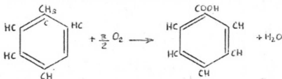
Il toluolo viene pompato in un reattore dove, alla pressione di circa 10 atmosfere, viene ossidato con aria in presenza di un adatto catalizzatore come schematizzato nella reazione.
